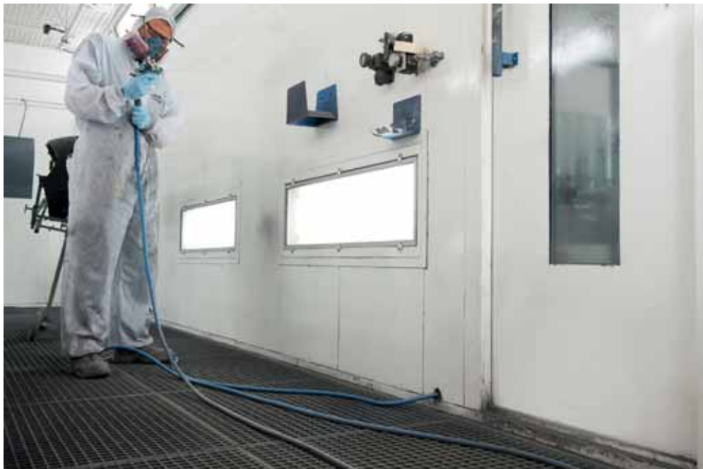
Wout sluit de stikstofleiding op de verfspuit aan. De verfspuit voelt warm aan. In het laatste deel van de slang zit nog een verwarmingselement. De slang is wel kwetsbaar.
