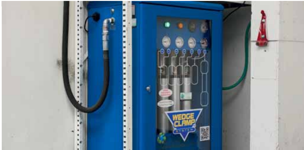
Normale perslucht gaat door een vijftraps filtersysteem van de Nitroheat en wordt gereinigd. In een membraam wordt de stikstof gescheiden van de andere gassen, waardoor 98 procent zuivere stikstof overblijft.
