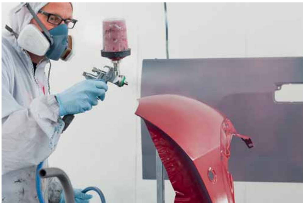
Stikstof is bewegingsloos, waardoor de lak veel gelijkmatiger naar het object gaat. De overspray neemt zoveel af dat een besparing van minimaal vijftien procent op de lakkosten haalbaar is.
